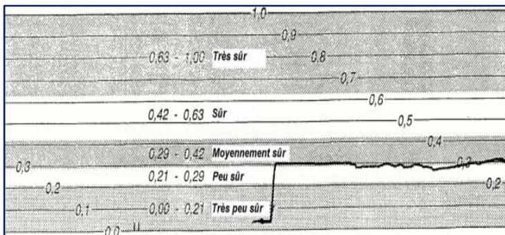
Mesure du coefficient de glissance avant traitement.
