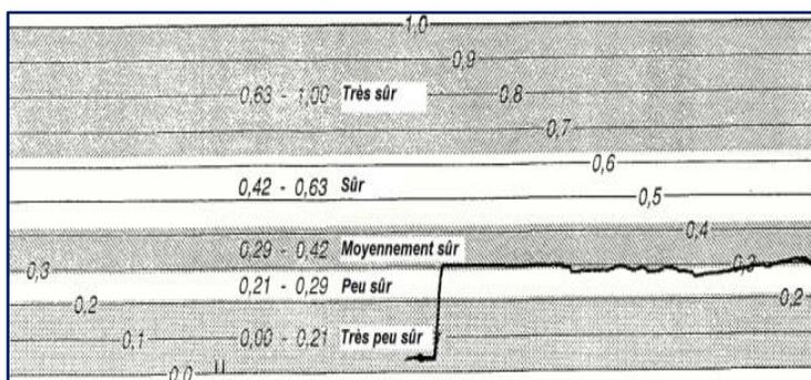
Mesure du coefficient de glissance avant traitement.
